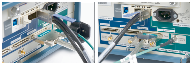
UltraSyncケーブルによるマルチ・チャンネル接続 左がマスタ、右がエクステンション
