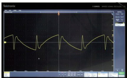
オシロスコープ上の波形 方形波をDUTに入力しているがインピーダンス不整合で波形が歪んでいる
