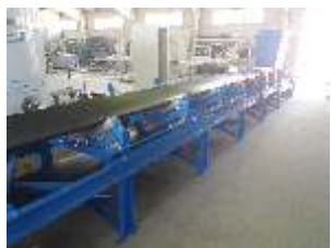
Proiectare, execuție, livrare, montaj, calibrare-etalonare - Sistem de dozare-cântărire bauxită în moara cu bile 2 & moara cu bile 3. ALUM Tulcea, România.
