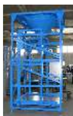
Proiectare, execuție, livrare, montaj, calibrare-etalonare - Sistem de cântărire și însăcuire în saci mari. Capacitate 500...1500kg, precizie 0,1%. ALUM Tulcea; BCG Ploiești; Fertil Plant Constanța, Romania.
